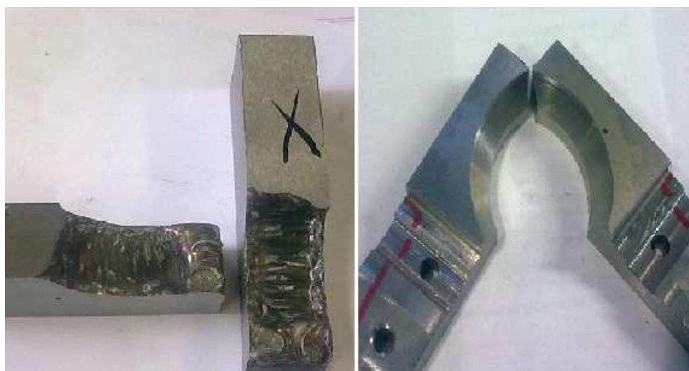
Obr. 7.28 Obráběný polotovár a vyhotovená součást
