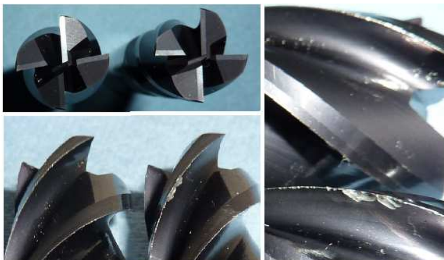
Obr. 7.27 Srovnání opotřebení nástroje
