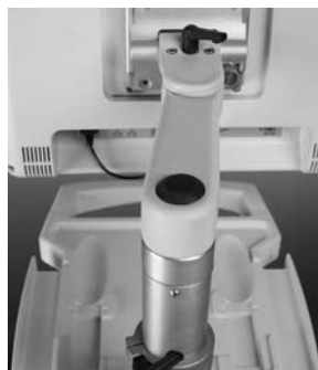
Figura 9 – Ajuste de la altura de la pantalla táctil
