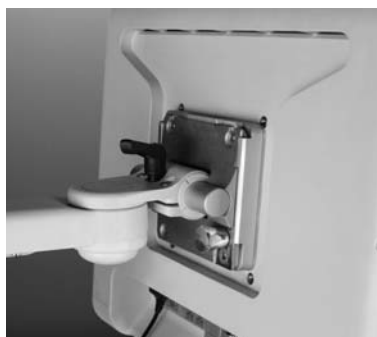
Obrázek č. 10 – Nastavení sklonu monitoru
