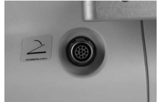
Ryc. 14 – Łączniki manipulatora i pedału nożnego
