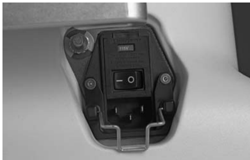
Εικόνα 12 – Κεντρικός διακόπτης τροφοδοσίας
