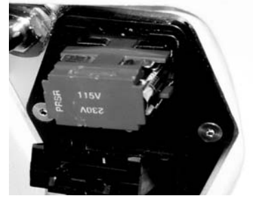
Şekil 19 – Sigorta Yönünü Değiştirme: 115V için yön gösterilmektedir
