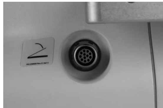
Figura 14 – Connettori driver e pedaliera
