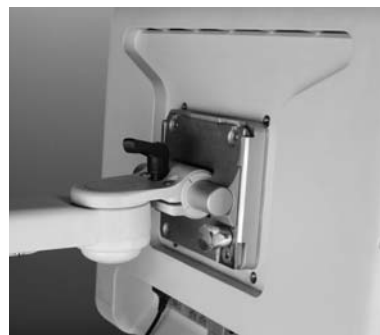
Figura 10 – Ajuste de la inclinación de la pantalla táctil
