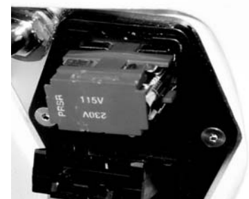
Figur 19 – udskiftningssikringens retning: Retning for 115 V vist
