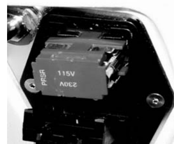
Abb. 19 – Sicherungsinstallation (Bsp.: 115 V-Sicherung)
