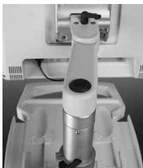
Afbeelding 9 – Hoogte van aanraakscherm aanpassen
