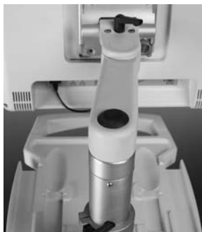
Abb. 9 – Anpassen der Touchscreen-Höheneinstellung
