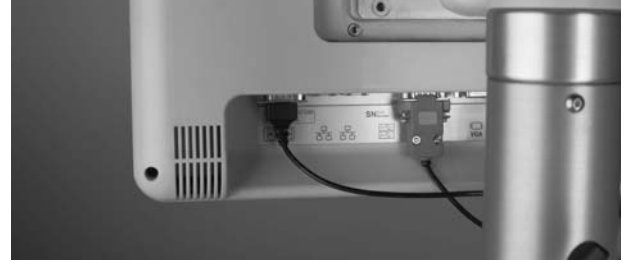
Şekil 7 – Dokunmatik ekran kablolarını bağlama Not: Gerçek konektör türü resimden farklı olabilir
