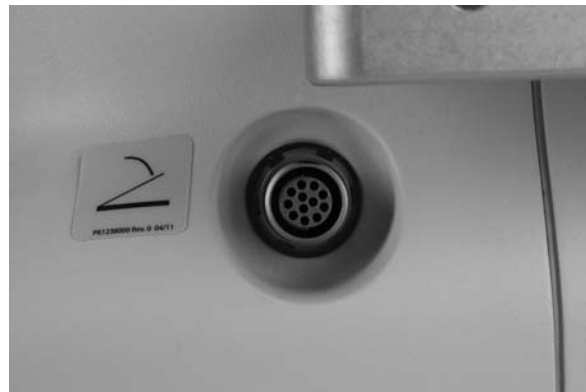
14. ábra – A célzó és lámpedál csatlakozói
