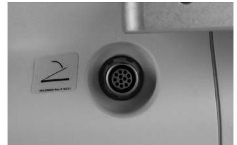
Εικόνα 14 – Υποδοχές σύνδεσης οδηγού και ποδομοχλού
