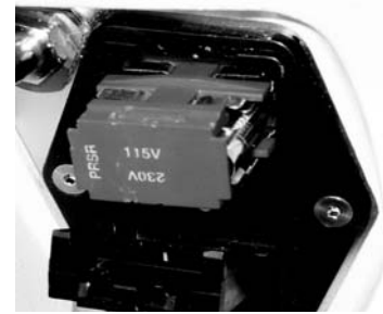
Afbeelding 19 – Oriëntatie vervangingszekering: Oriëntatie voor 115 V afgebeeld
