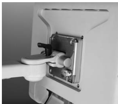
Figura 10 – Ajustar a inclinação do ecrã táctil
