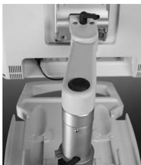
Obrázek č. 9 – Nastavení výšky monitoru
