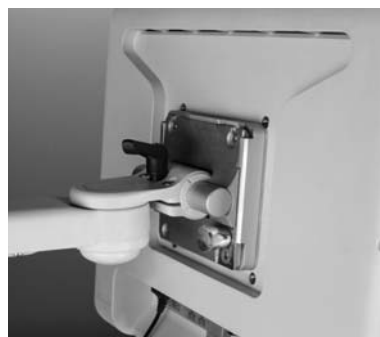
Kuva 10 – Kosketusnäytön kallistuksen säätäminen
