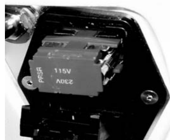
Рис. 19. Расположение предохранителя при замене: показано расположение для предохранителя 115 В
