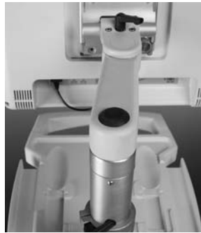
Şekil 9 – Dokunmatik ekranın yüksekliğini ayarlama
