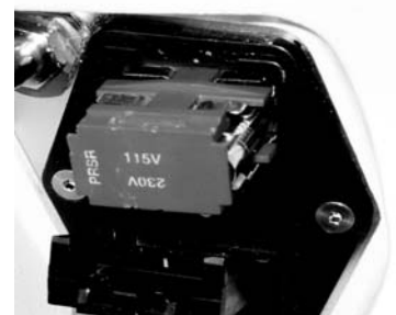
Figure 19 – Remplacement des fusibles Orientation : Orientation pour 115 V illustrée
