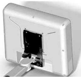
Рис. 6. Подсоединение сенсорного экрана к основному блоку
