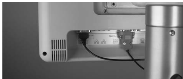
Abb. 7 – Anschließen der Touchscreen-Kabel Hinweis: Das tatsächliche Aussehen des Konnektors kann von der Darstellung abweichen
