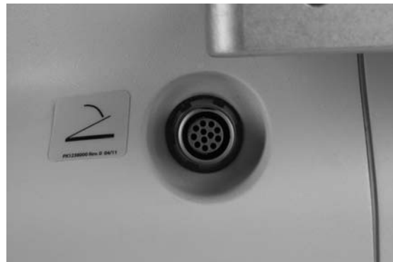
Obrázek č. 14 – Konektory ovladače a pedálů
