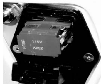
Figur 19 – Byta säkring: Riktning för 115V visas
