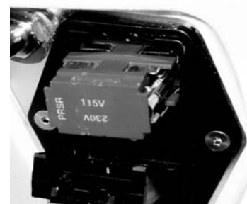
圖 19 - 保險絲更換方向：顯示的是 115V 的方向
