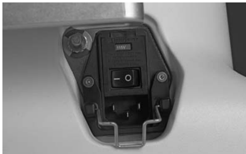
Figura 12 – Interruptor principal de encendido
