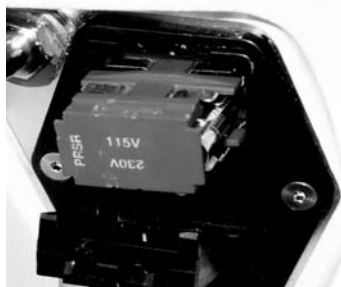
19. ábra – A pótbiztosíték behelyezésének iránya: az irány 115 V esetén
