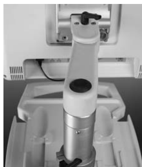
Kuva 9 – Kosketusnäytön korkeuden säätäminen
