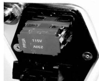
Ryc.19 – Orientacja wymiany bezpiecznika: pokazana orientacja dla 115 V
