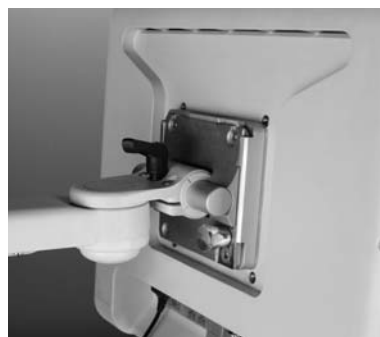
Afbeelding 10 – Kanteling van aanraakscherm aanpassen
