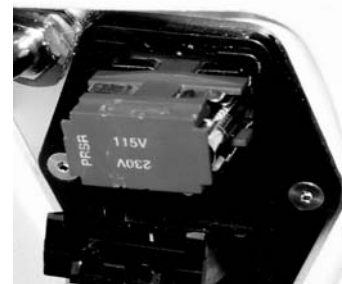
Figura 19 – Orientação para substituição dos fusíveis: Orientação para fusíveis de 115 V
