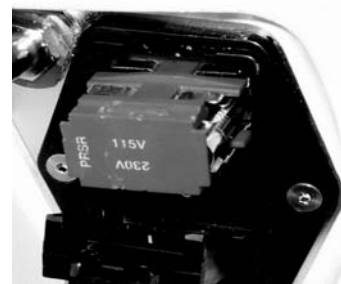
Figura 19 – Orientación para reemplazar el fusible: Se muestra la orientación para 115 V
