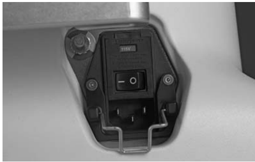
Ryc. 12 – Przełącznik głównego zasilania
