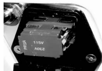
Figura 19 – Orientamento del fusibile di sostituzione: orientamento per 115V illustrato
