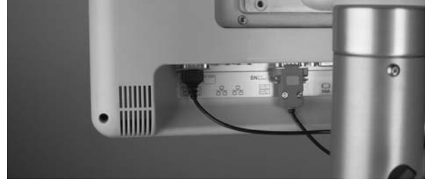
圖 7 - 連接觸控螢幕纜線 註：實際接頭式樣可能與插圖不同
