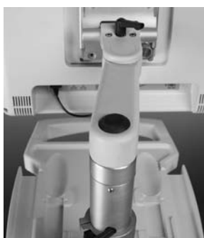
Figura 9 – Regolazione dell'altezza del display a sfioramento
