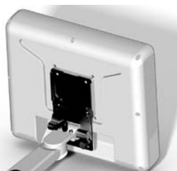
Ryc. 6 – Dołączanie ekranu dotykowego do jednostki głównej
