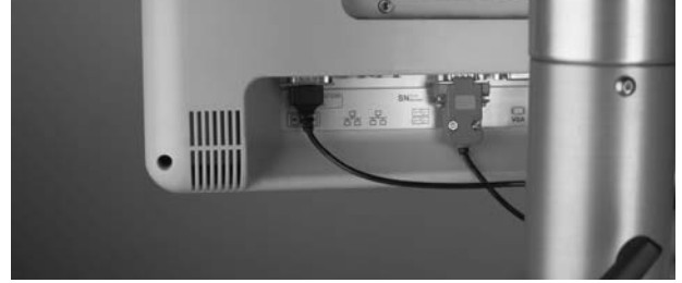
그림 7 - 터치 스크린 케이블 연결하기 참고: 실제 커넥터 방식은 그림과 다를 수 있습니다.
