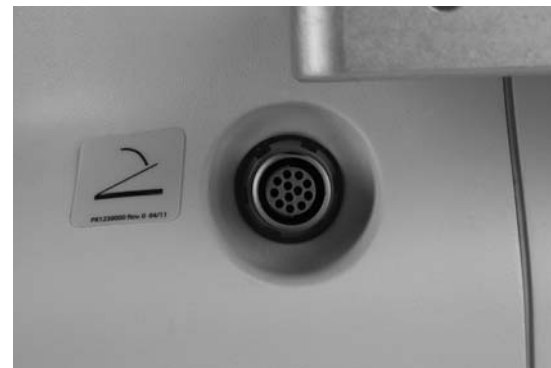
Afbeelding 14 – Connectors driver en voetpedaal
