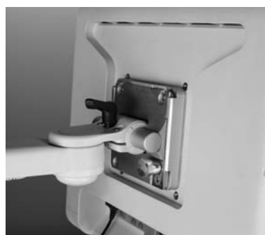
Figura 10 – Regolazione dell'inclinazione del display a sfioramento
