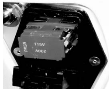
Obrázek č. 19 – Uspořádání při výměně pojistek: zobrazeno uspořádání pro 115 V
