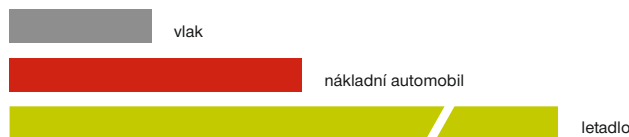
Relativní spotřeba paliva na tunokilometr – letadlo spotřebuje 60x více paliva na dopravení tuny nákladu než nákladní automobil
