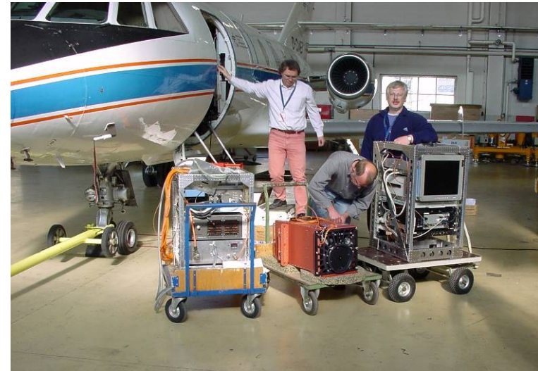
Komponenten des 2 \mu m Doppler Wind Lidars für die Windprofilmessung auf der Falcon (ca. 170 kg)
