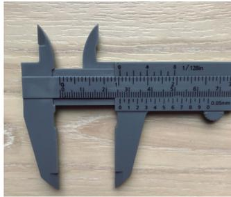
1. Tras ajustar la medida al elemento deseado, para interpretar el valor tomado, en primer lugar, se observa la escala fija, en concreto, la posición en la que el 0 del nonio se encuentra situado con respecto al calibre, y se apunta el valor completo de la cifra superada en la medida en la escala fija. En el primer caso, 26 mm.
