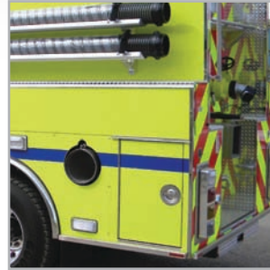
Descarga eléctrica lateral redonda de 10 in
