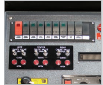
Control de válvula de descarga dentro de la cabina
