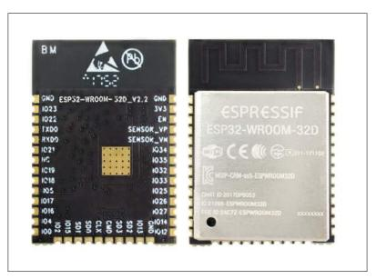
Figure 22: ESP32-WROOM-32D(ESP-WROOM-32D) Module
