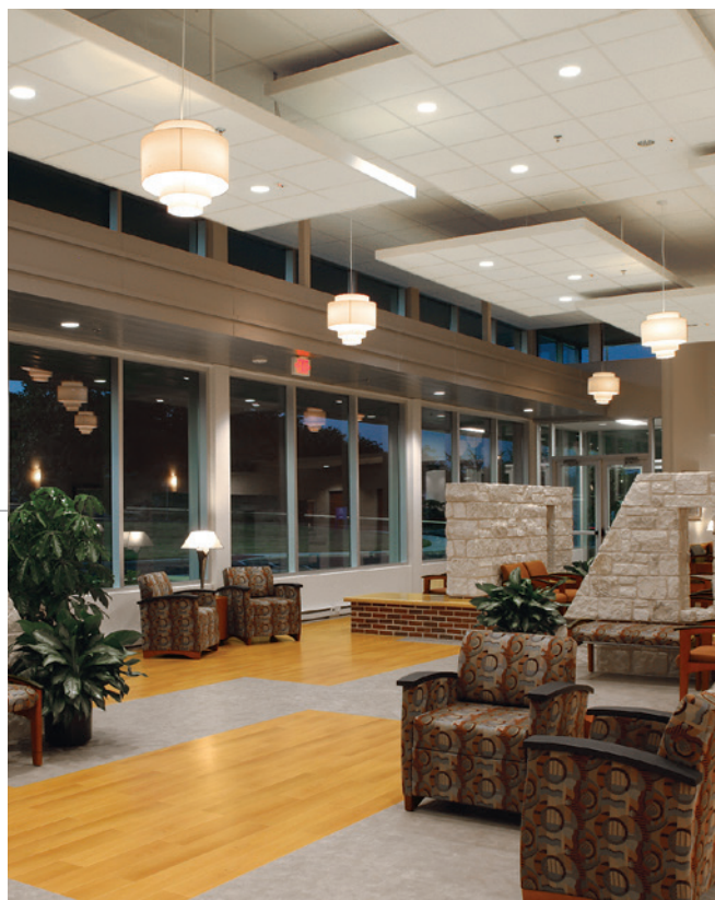
Plafones Ultima®1911 con sistema de suspensión Prelude® XL® 15/16" y borde Axiom® Classic de 4" y 6".
