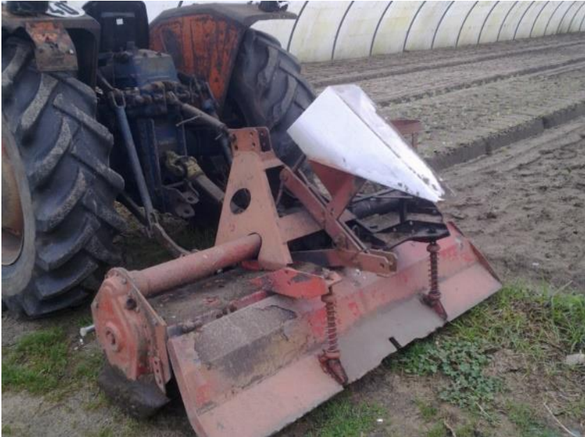
Figura 2.5. Fresa com abridor de regos.
