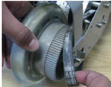
8. Enlevez la courroie de la poulie et regardez les pièces
