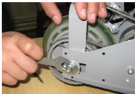
10. Retendre la courroie, remettre et revisser les écrous.
