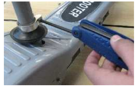
3. Dévissez la vis de la bride avec une clef 6 pans
