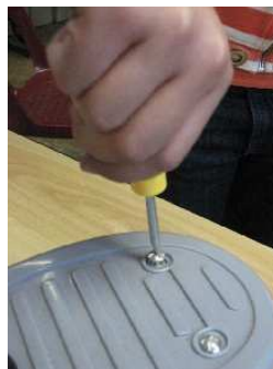
5. Dévissez les quatre vis du cache
