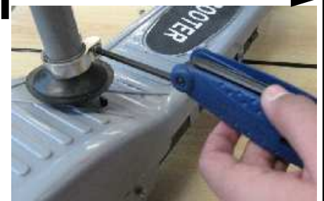
12. Repositionnez la rondelle, le tube de selle et resserrez la bride
