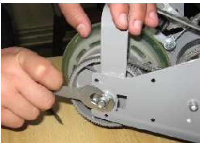
7. Dévissez complètement un écrou avec une clef plate
