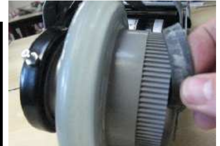
9. Repositionnez la courroie sur la poulie
