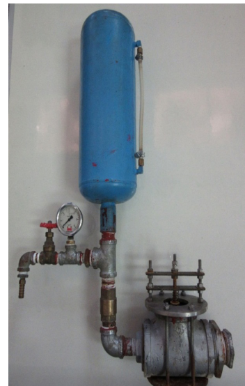
Figura 4. Fotografía frontal de la bomba de ariete hidráulico BAH 1.1/2.
