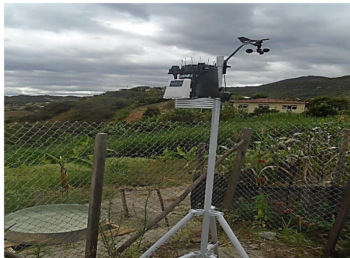
Figura 12. Estación meteorológica automática
