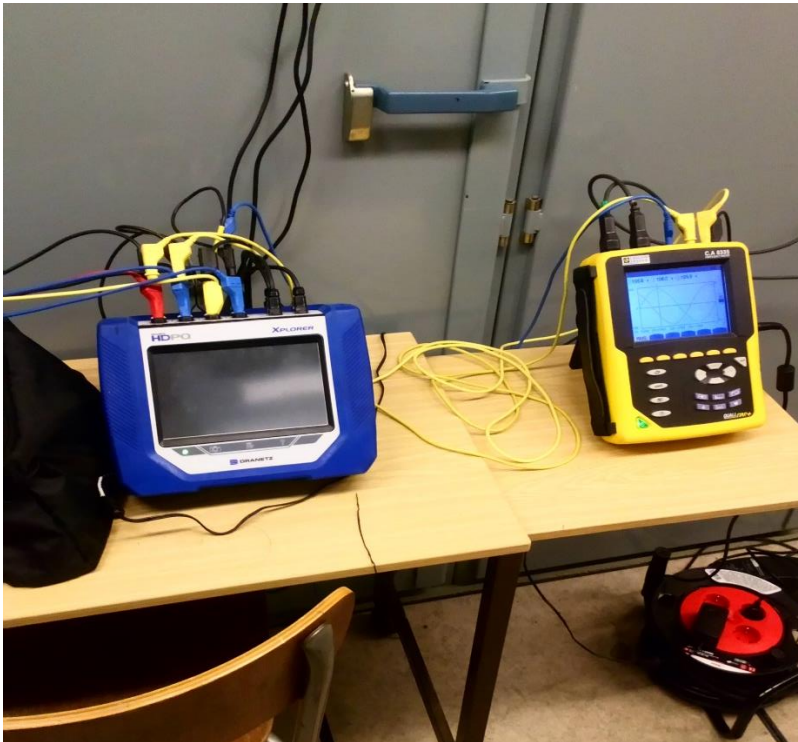
Figur 14.1. Instrumenten – Dranetz HDPQ och Chauvin Arnoux
