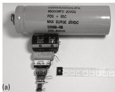
Capacitores variados. (a) capacitores electrolíticos diversos usados en circuitos de baja tensión. (b) capacitor variable para sintonía de radio. (c) capacitores utilizados en líneas de distribución de 15.000 V.
