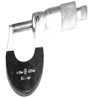
Micrómetro o calibrador palmer ( web.unicam.it/.../lab-cam/micrometro.htm )
