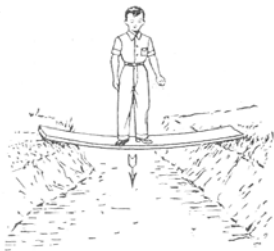
El peso de este hombre deforma al pequeño puente.
