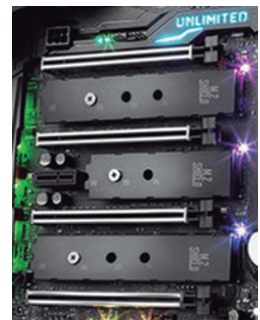
Figura 2.5 Detalle de placa con tres puertos M.2.
