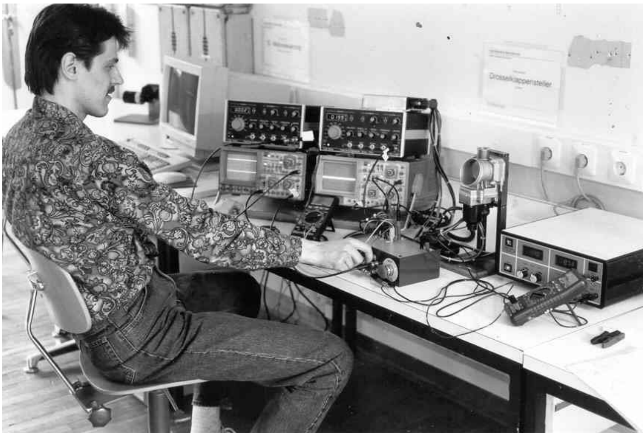
Messplatz für elektronische Motorleistungssteuerung (E-Gas)
