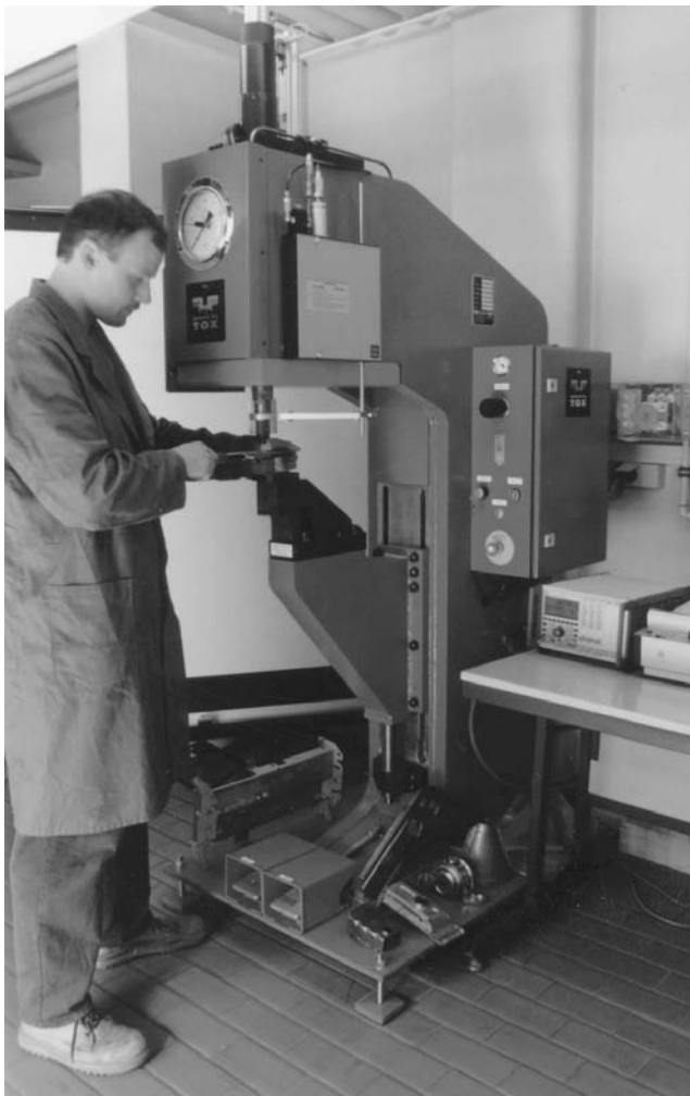
Universal-Einzelfügemaschine TOX CEU 15
