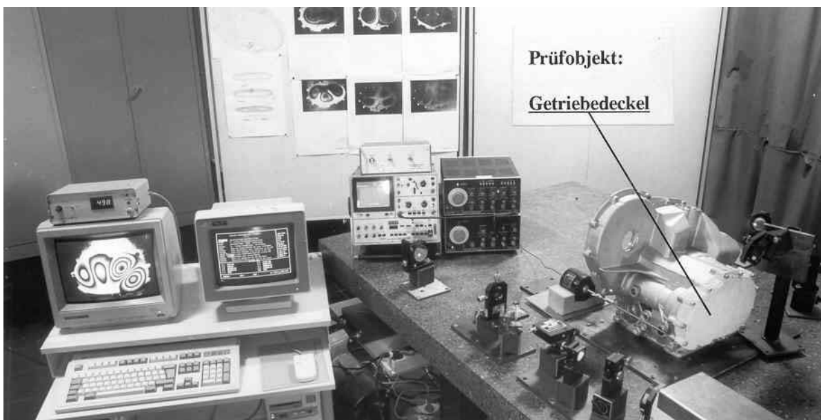
Messeinrichtung für stroboskopische Holografie
