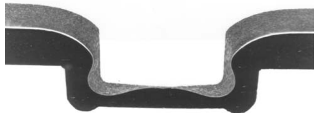
Schliff durch 8mm Stahl-Aluminium-Toxfügung an Karosserieblechen
