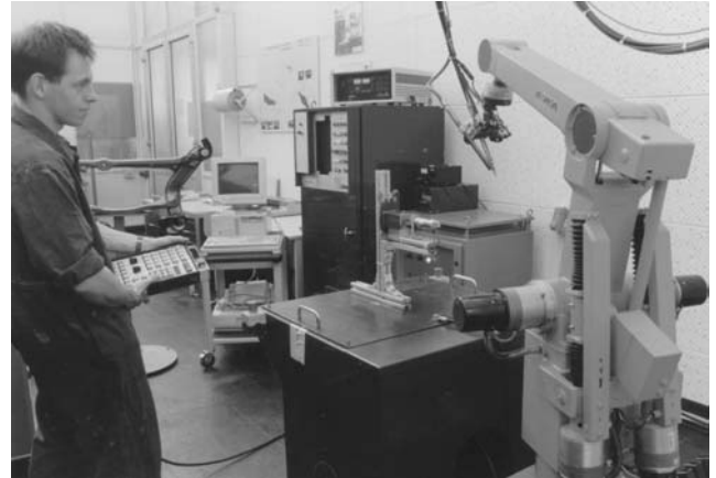
Vertikalknickarm-Roboter mit MAG-Schweißanlage mit programmierbarer Schweißsteuerung
