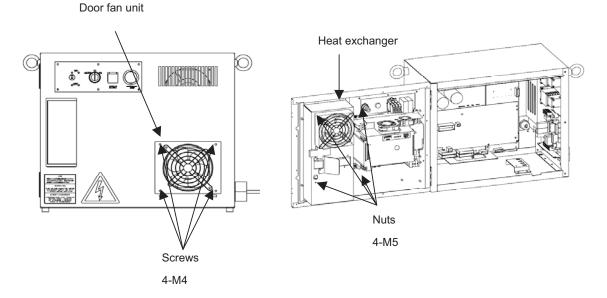
Fig.7.8.1 (a) Replacing the door fan unit
