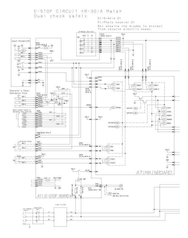
Fig. A (d) Emergency stop circuit diagram (ARC Mate 120*i*C, M-20*i*A, ARC Mate 100*i*C, M-10*i*A, ARC Mate 50*i*C)
