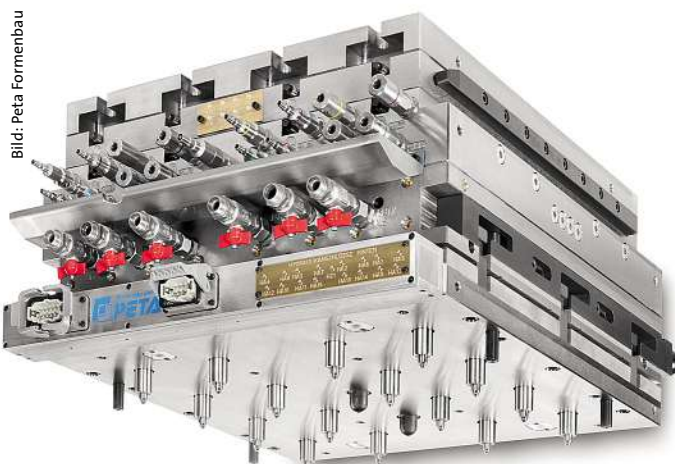
Werkzeug mit 16-fach Nadelverschlusskaltkanaltechnik.
