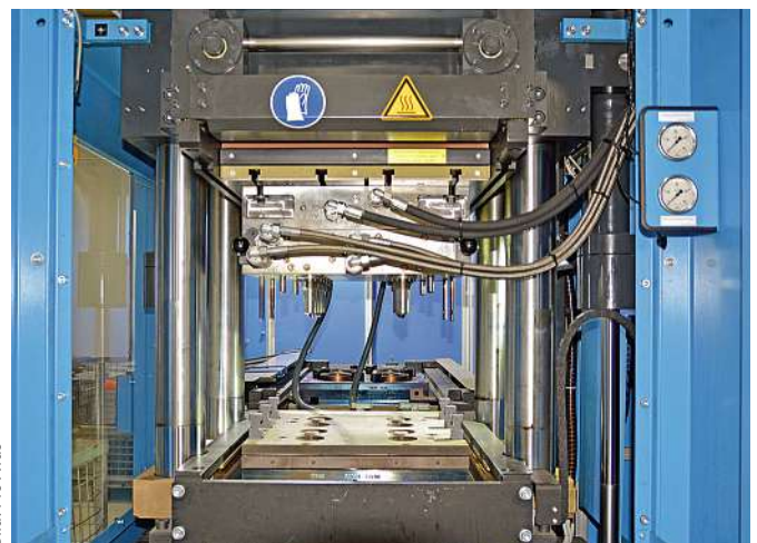
Der Fast Double Shuttle ermöglicht eine synchrone Mittelplattenverschiebung in einem schnellen Zyklus.
