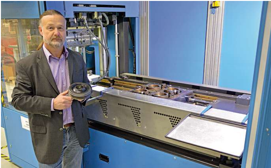
Michael Metzinger, Entwicklung Elastomertechnik (Material-Prozess-Werkzeug) sieht in der ergonomischen Bedienerhöhe der vertikalen Maschine eine Erleichterung für das Einlegen und die Entnahme ohne zusätzliche Podeste.
