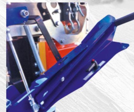
Manettes d'actionnement mobile sur deux axes.
