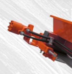
Moteur hydraulique positionné en haut pour une traction majeure.
