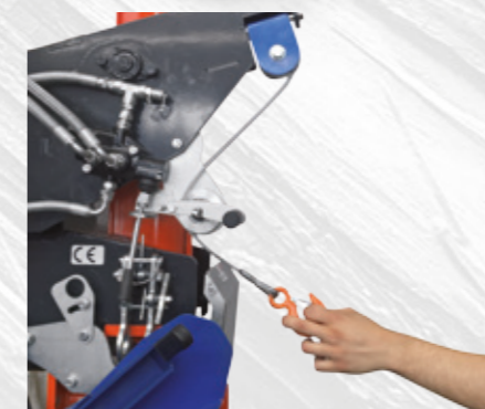
Treuil 1 tonne avec déroulage automatique.
