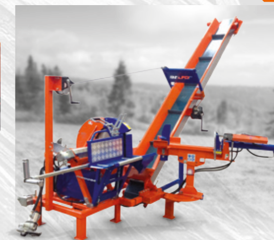
Moteur hydraulique positionné en haut pour une traction majeure.
