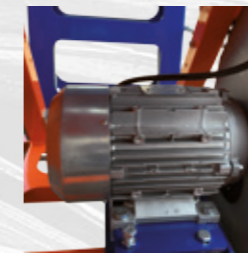
Moteur fabriqué en Italie avec frein automatique.
