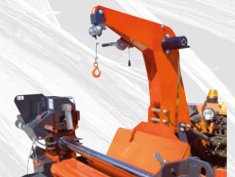
Treuil 1 tonne avec déroulage automatique.
