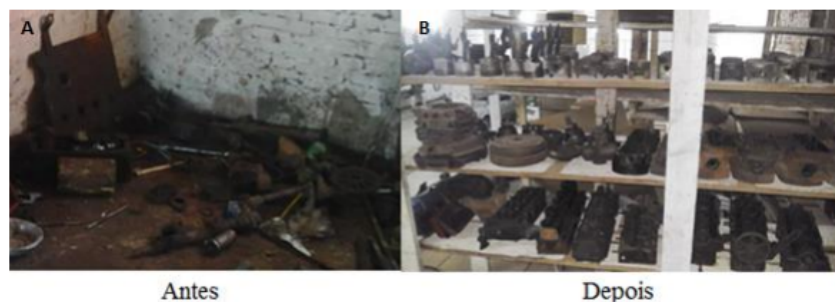
Fotografia 2 – Melhorias: gestão visual através da aplicação do 5S na área de manutenção automotiva.
