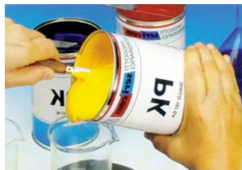
Figura 2: Tinta para flexo. La tinta; es muy fluida y de componentes volátiles
