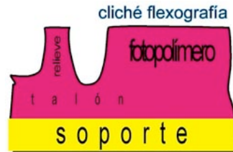
Figura 7: El cliché flexo se obtiene al procesar la plancha flexo
