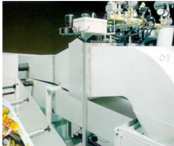
Figura 11: El horno de secado tiene la misión de facilitar el secado de la tinta sobre el soporte
