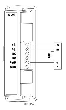
Figure 6-1. MVS Wiring
