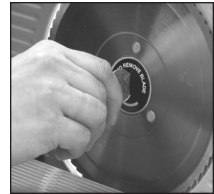
Figure 7. Tournez la vis dans le sens des aiguilles d'une montre pour retirer la lame.
