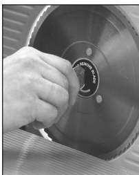
Figura 7. Girar el tornillo hacia la derecha para quitar la cuchilla.
