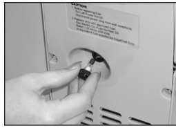
Figure 10. Remplacer le fusible situé sous le boîtier du moteur.
