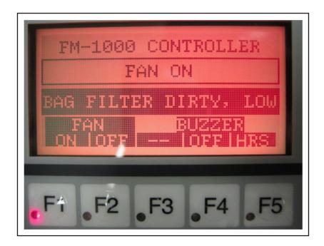
FIGURE 18-1 DISPLAY PANEL DIRTY BAG FILTER CONDITION
