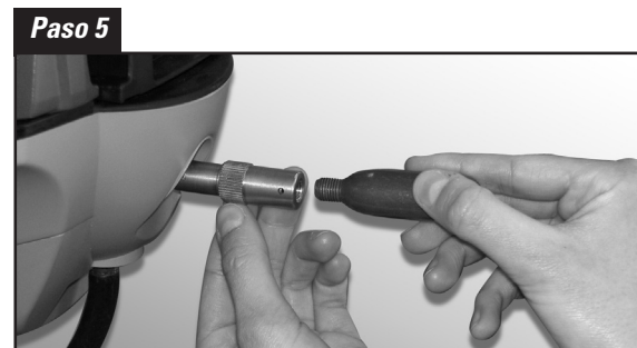
Mientras sujeta el adaptador en su lugar, entornille el cartucho Quick Clear en el adaptador Quick Clear.
