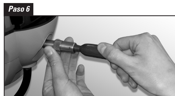
Para empezar el proceso de limpieza, sujete el adaptador Quick Clear en su lugar y desentornille el cartucho Quick Clear. 1/4 de vuelta solamente.
