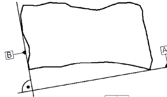
Bild 2: Bezugssystem BA aus den Ebenen B und A
