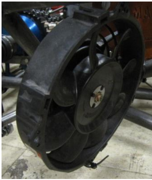
Actual photo of fan on chassis
