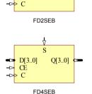
Inputs Output S С D CE Q ↑ 1 х х 1  $Q_0$ 0 0 х Х ↑ 0 1 d d
