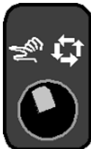
Abb. 1 : Pumpen Betriebsarten Wahlschalter Links = manueller Betrieb Rechts = Automatikbetrieb
