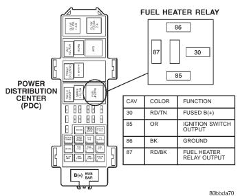
Fig. 22 Power Distribution Center (PDC)
