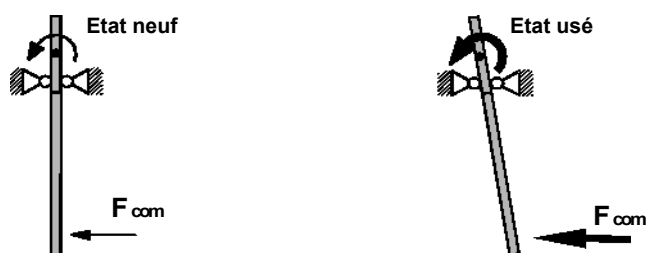
« SAC » à l'état neuf et en cas d'usure avant et après compensation
