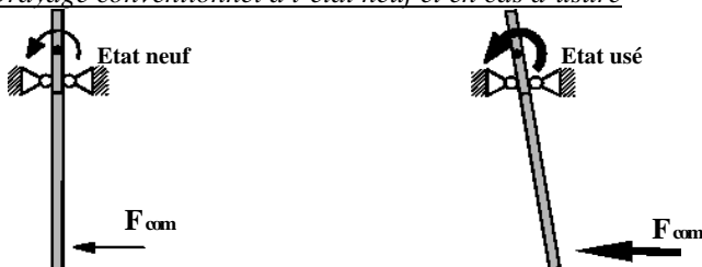
Embrayage conventionnel à l'état neuf et en cas d'usure
