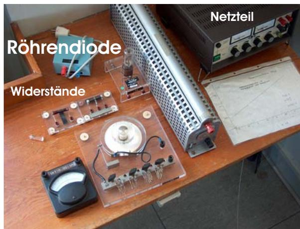
Bild 20.1: Ein Bild des Versuchs »Diode«.
