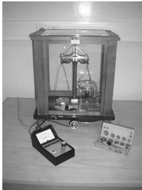
Bild 10.1: Der Versuch »Potentialwaage«.
