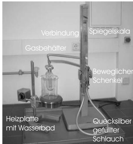
Bild 5.1: Der Versuch »Gasthermometer«.
