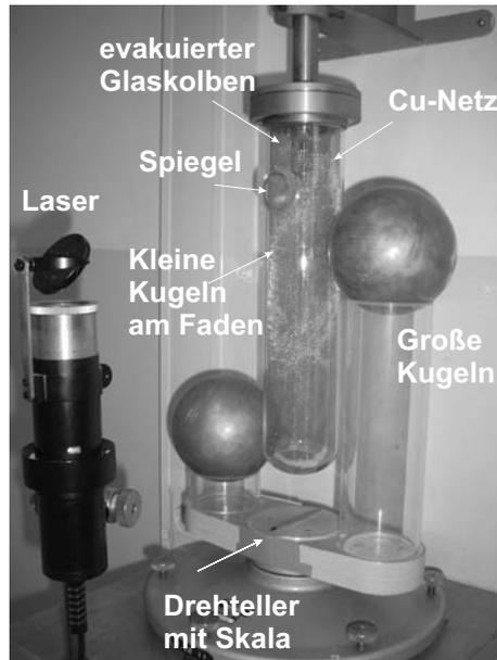
Bild 2.1: Gravitationswaage bestehend aus 2 an einem Torsionsfaden aufgehängten kleinen Kugeln in einem evakuierten Glaskolben, mit einem Spiegel am Faden und einem umgebenden Kupfernetz. Der Spiegel wird mit einem Laser beleuchtet und auf einer gegenüberliegenden Skala abgebildet. So wird die Torsion des Fadens sichtbar.
