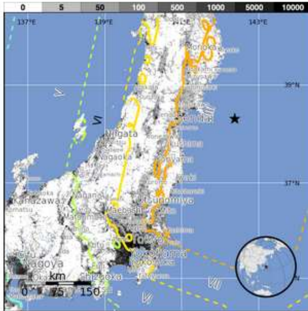
Figure 6. Cartes des iso-intensités, séisme de Sendai, 11 mars 2011
