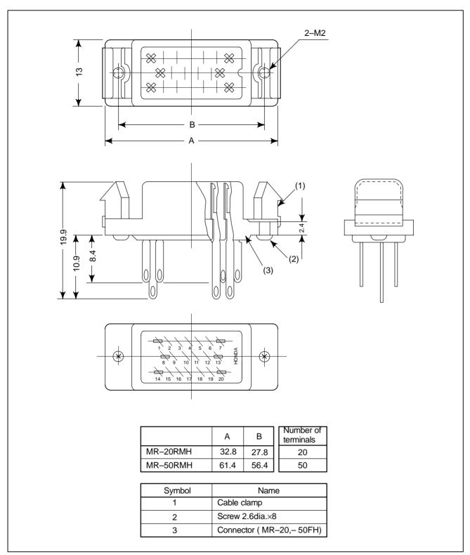
Fig. C4 (d) HONDA connector (female)
