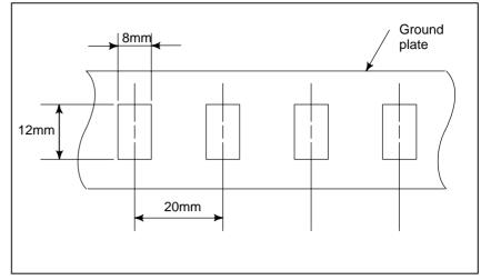
Fig. 3.5.5 (d) Ground plate holes
