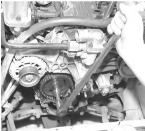
Fig. Fig. 3: Unfasten the camshaft sprocket bolt
