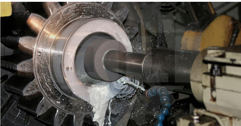
Esempio di rettifica interna con uso di liquido lubrorefrigerante.
