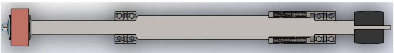
Sezione albero – Cuscinetti in tandem con disposizione ad "O"
