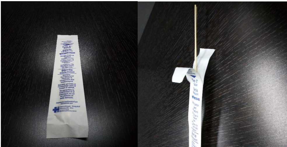
Figura N° 26. Aplicadores de madera con punta de algodón en su empaque de papel, mismo que puede usarse como embalaje interno ya que su material facilita el secado y por su naturaleza no se quiebra como un tubo de vidrio. Fuente propia.
