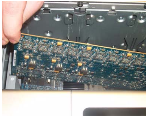
Figura 3. Deslizamiento de la parte frontal de la tarjeta en el soporte de tarjeta PCIe
