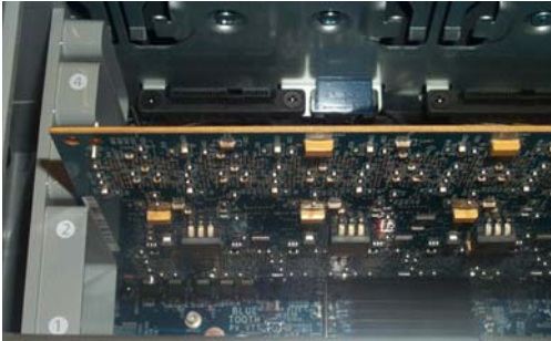
Figura 4. Tarjeta PCIe instalada
