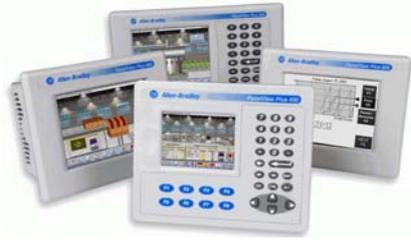
Os terminais PanelView Plus 400 e 600 menores combinam uma tela de 4 ou 6 pol. na mesma unidade básica com a lógica, memória, alimentação e entrada do operador. As telas em cores ou em escala de cinza renderizam imagens de 18 bits em cores ou 32 níveis de cinza. As opções de entrada flexíveis incluem teclado, touchscreen ou combinação de teclado/touchscreen. Outros recursos importantes incluídos são:
