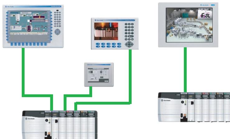
Esta configuração fornece uma IHM no nível local típico mostrando uma rede com FactoryTalk View SE com computadores e monitores industriais e um controlador Logix.
