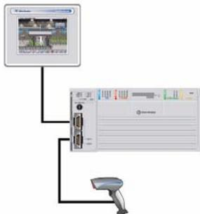
Na figura 3, um terminal PanelView Plus Compact e o sistema 1769-L3x CompactLogix fornecem uma solução integrada para aplicações porte. Geralmente, essas aplicações são aplicações de controle no nível de máquina que requerem uma pequena quantidade de E/S e mais recursos de comunicação que a conectividade serial.
