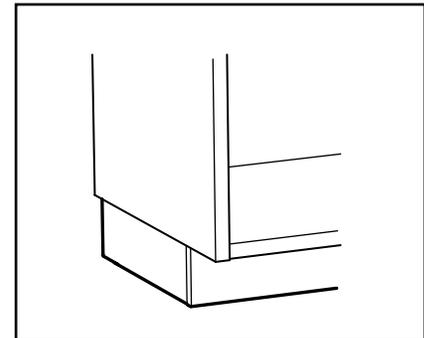
**Plinthes:** à installer sous les armoires SEKTION et à fixer sur les pieds SEKTION.
