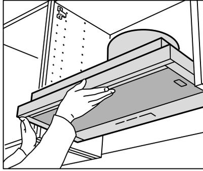
Installez maintenant la hotte. La plupart des hottes vendues chez IKEA présentent deux options: d'abord la version à extraction, la plus commune, qui se raccorde à un conduit d'évacuation et l'autre, qui fonctionne avec un filtre à charbon pour recirculation de l'air. Chaque mode d'installation est décrit dans la notice fournie à l'achat.
