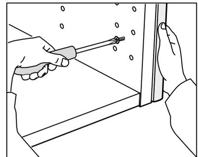
Si vous installez une armoire haute, n'oubliez pas de couvrir la paroi latérale d'un panneau de finition avant d'installer le caisson suivant.
