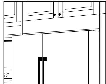
**Panneaux-décor:** à couper à partir d'un panneau de finition d'une épaisseur de  $\frac{1}{2}$  po ou d'un panneau latéral de  $\frac{3}{8}$  po. Pour créer un panneau-décor au-dessus du réfrigérateur, utiliser une façade de tiroir de 5 po de largeur.
