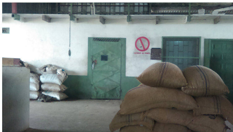
Figure 19 - Bonne pratique de stockage du poivre : aération du bâtiment, rangement et disposition des sacs, présence des pictogrammes
