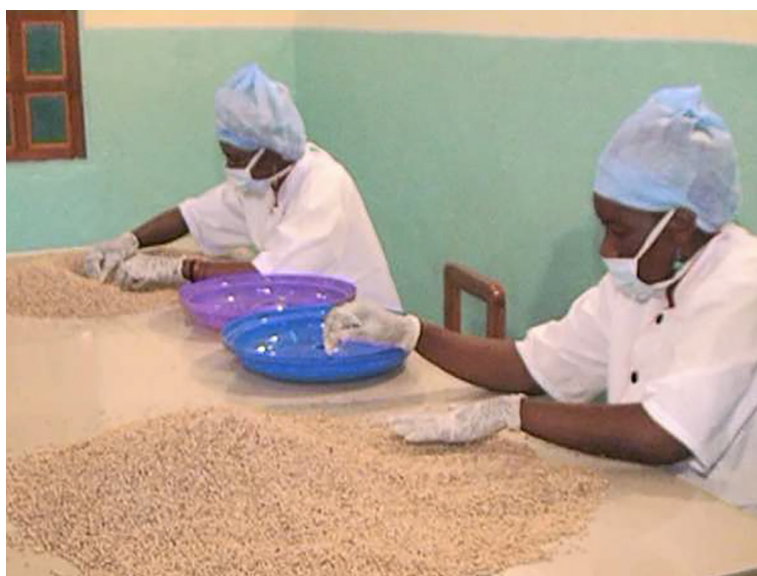
Figure 18 - Bonne pratique de triage en station du poivre blanc : opératrices disposant des EPI appropriés
