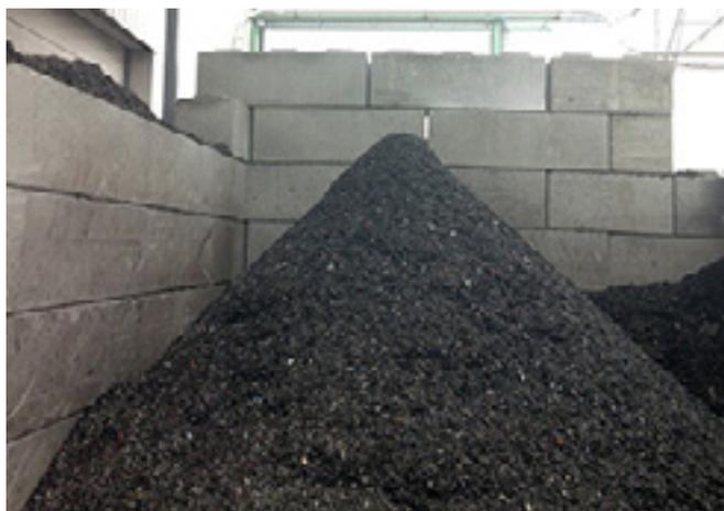
Photo 50 - Chips de déchets de membranes d'étanchéité bitumineuse après broyage et dépollution - RECOVERING
