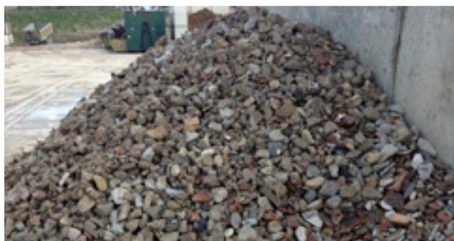
Photo 23 : Grave 30 – 90 en sortie de chaîne de tri de déchets inertes – Big Bennes
