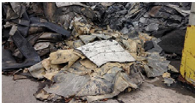
Photo 49 - Déchets de membranes d'étanchéité bitumineuse post-consommation - RECOVERING
