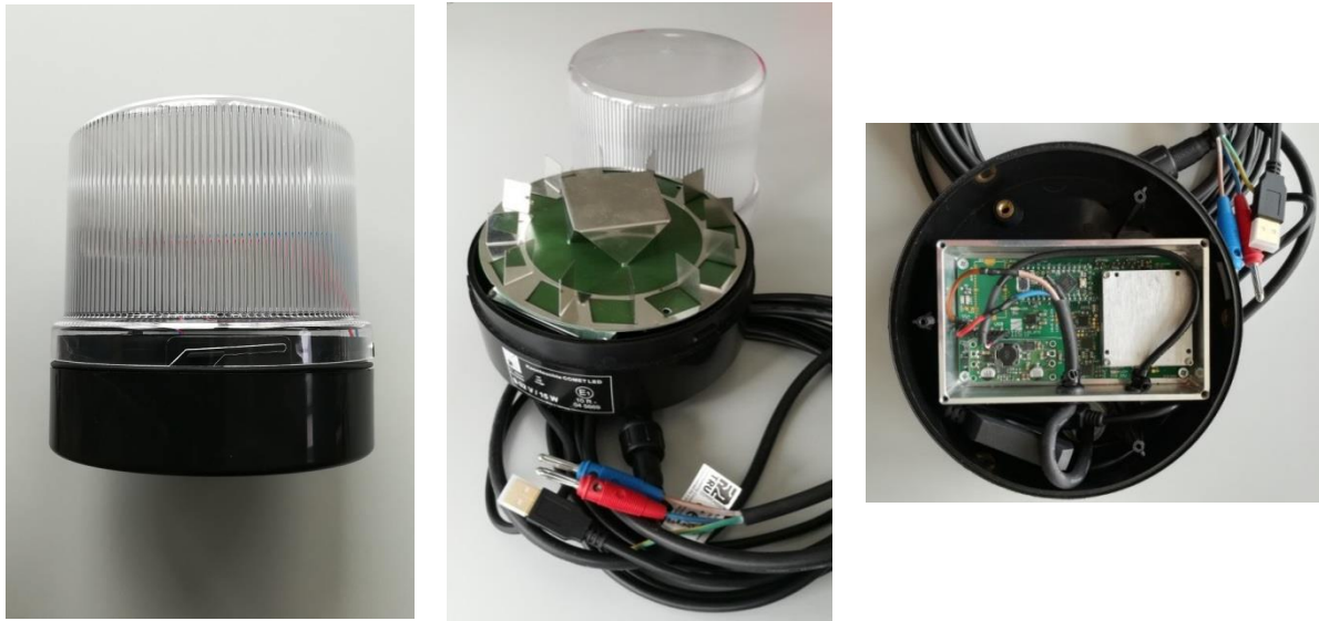
Abbildung 4: Galileo-PRS fähige Multiband-GNSS-Antenne mit integrierter Inertialsensorik.
