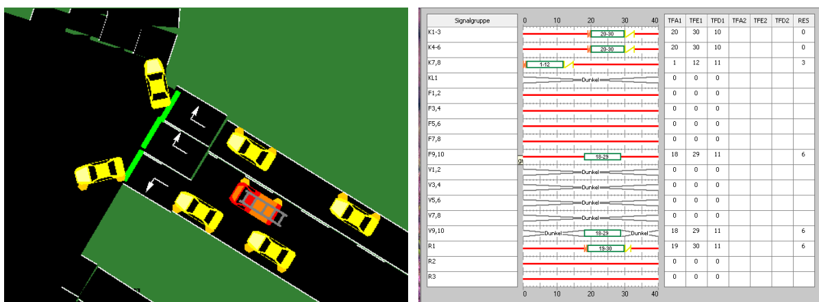
Abbildung 6: SUMO-Simulationsmodell mit hinterlegten LSA-Schaltplänen und Verkehrsnachfrage (links) und entworfener Feuerwehrplan im Programm Siemens Sitraffic Office zur Bevorrechtigung (rechts).
