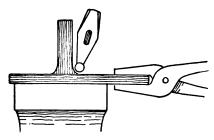
Fig. 36. Making a Jump Weld
