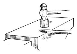
Fig. 23. Hammering the Steps
