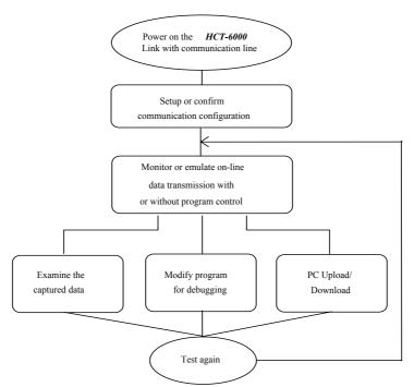
Figure 4-1 : NORMAL OPERATION FLOW CHART
