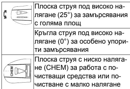
Кръгла или плоска струя да се избере посредством безконтактно превключване:
