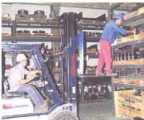
Fig. 4 – É expressamente proibida a deslocação vertical de pessoas sobre os garfos do empilhador.
