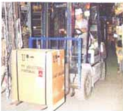
Fig. 8 – O tamanho (largura e altura) da carga deve ser adequado aos limites do empilhador.
