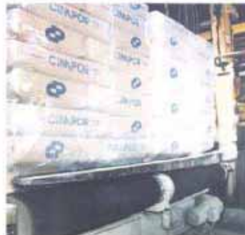
Fig. 6 – O tipo de estivoamento da carga permite, neste caso, a deslocação da carga sem o recurso a plataformas ou paletes.
