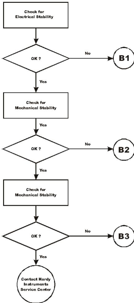
**FIG. 6-3 GUIDELINES FOR INSTABILITIES ON FORMERLY OPERATING SYSTEMS**
