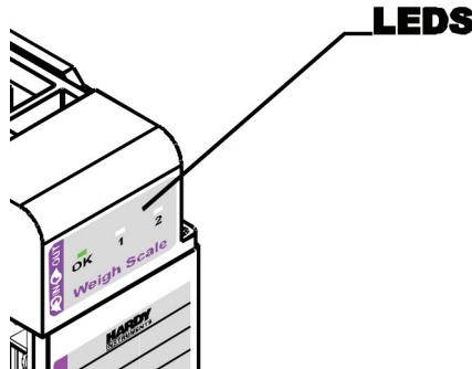
**FIG. 4-2 MODULE LEDS HI 1769-2WS DUAL CHANNEL**
