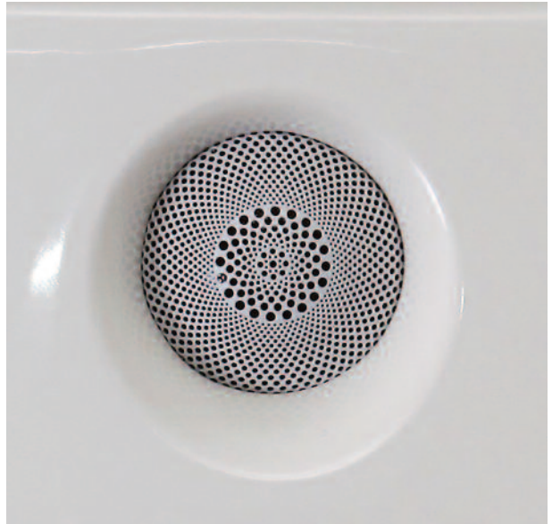
Particolare del tweeter, a dome morbido ricoperto con copertura fissa
